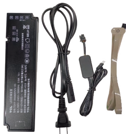
★ 电源适配器 (PWWX0311) 按套下单 1、定功率为60W; 2、内含薄膜开关, 可调节灯带亮度, 薄膜开关可选择装或不装, 薄膜开关安装详见说明书; 3、最多可接12米灯带 (灯带功率为5瓦/米);
